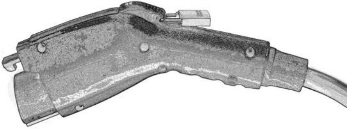
Figura 6: Candado Utilizado en Combinación con la Funda del Conector después de la Carga
